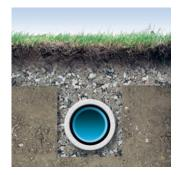
En application de drainage, les géotextiles Fibertex permettent le libre passage de l'eau tout en filtrant les fines. Ils empêchent de cette manière le colmatage progressif des tuyaux de drainage, tranchées ou autres systèmes d'évacuation de l'eau.
