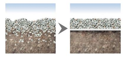
Les géotextiles Fibertex ont un rôle anticontaminant. Grâce à leur grande perméabilité, ils permettent le passage de l'eau tout en évitant le mélange des couches de construction.
